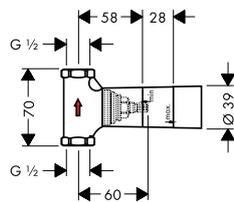
**Скрытая часть запорного вентиля, СМ, шпindelная 1/2'**
