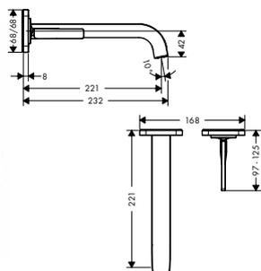
**Смеситель для раковины, однорычажный, с розетками и изливом 220 мм, настенный монтаж**
